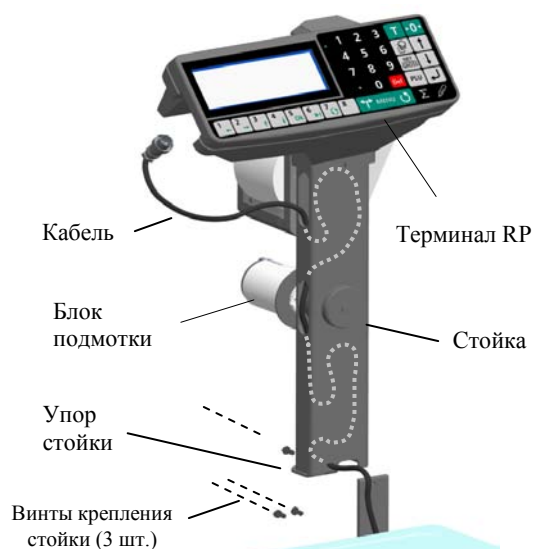
Рис. 3.3 - Сборка весов МК_RP10-1, МК_R2P10-1
